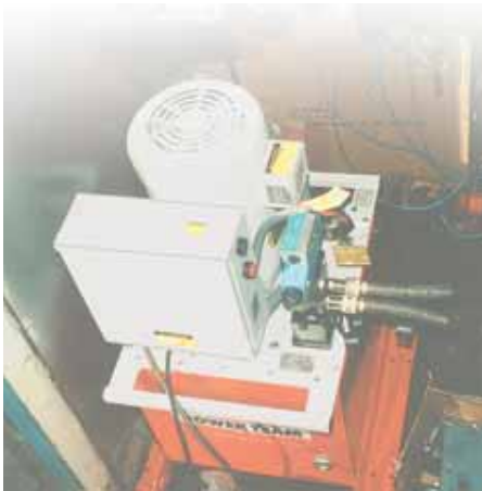
Применение насоса PE4004S с цилиндром RD3006 на специальном прессе для ремонта поврежденных звеньев цепи для судостроительной промышленности.
